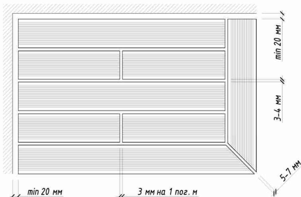
Рис. 6.2. Зазоры укладки террасной доски
