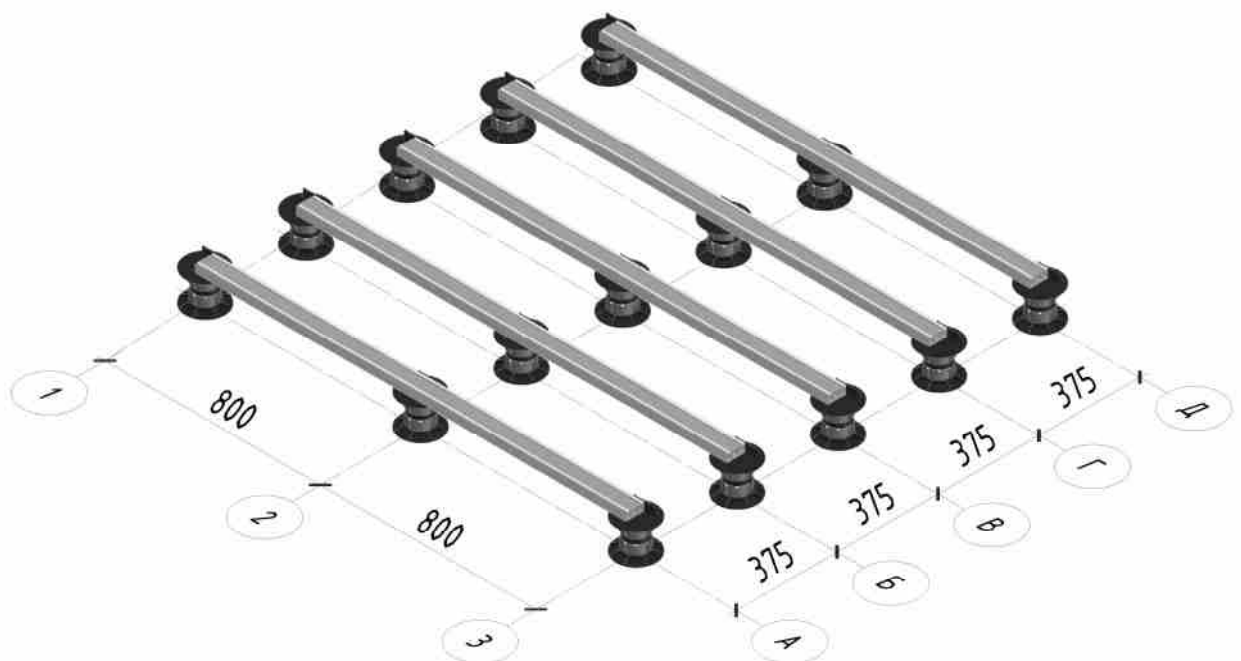
Рис. 4.1. Схема расположения регулируемых опор при использовании алюминиевой лаги 61/67
