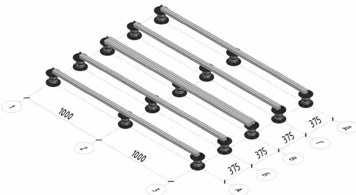
Рис. 4.3. Схема расположения регулируемых опор при использовании алюминиевой лаги 100
